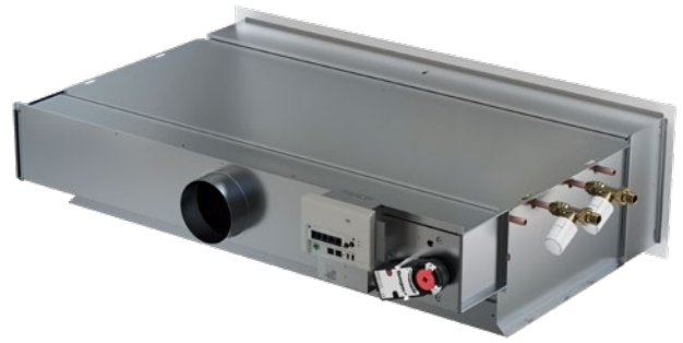
Figure 12. WISE Paragon Wall complet avec module de commande WISE CU, servomoteurs, vannes et servomoteurs pour chauffage ou refroidissement par eau montés en usine.
