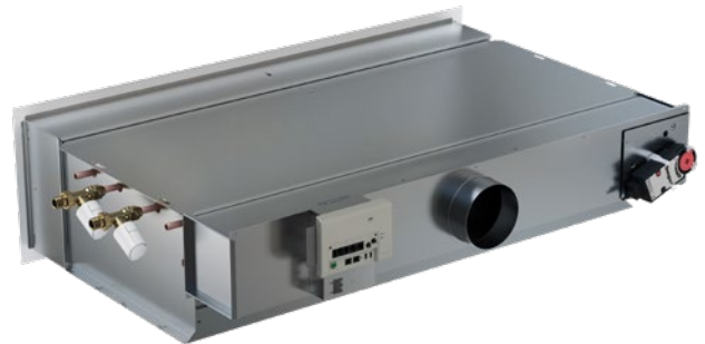
Figure 13. WISE Paragon Wall avec raccordement hydraulique sur le côté gauche. Produit complet avec module de commande WISE CU, servomoteurs, vannes et servomoteurs de vannes pour chauffage ou refroidissement par eau montés en usine.
