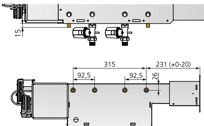
Abb. 19. Maße Wasseranschluss
