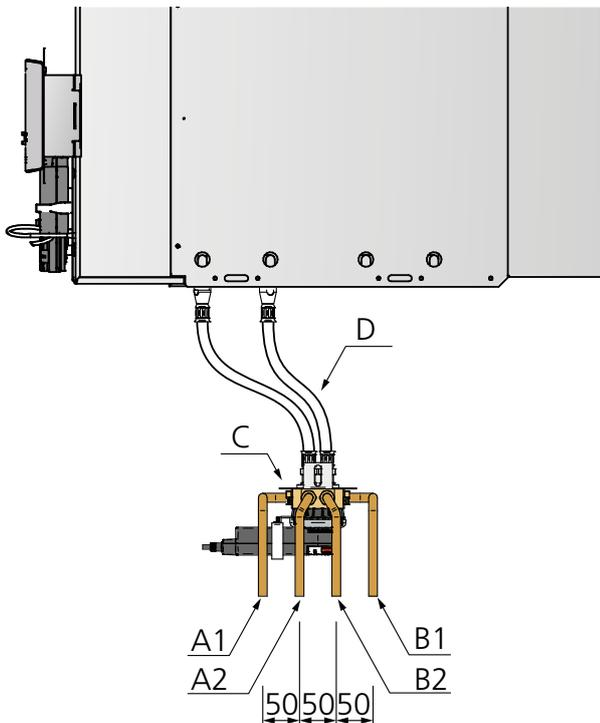
Abb. 23. Wasseranschluss, CCO-Ventil, (WB)..
