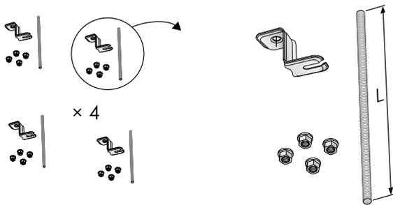
Abb. 18. Montageteil SYST MS M8-1, Deckenbefestigung und Gewindestange
