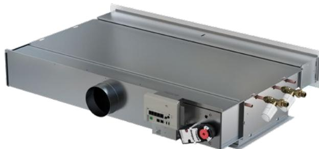
Abb. 12. WISE Paragon, komplett mit werkseitig montierter Steuereinheit WISE CU, Stellantrieben sowie Ventilen und Ventilstellantrieben für Kühl- und Heizwasser.
