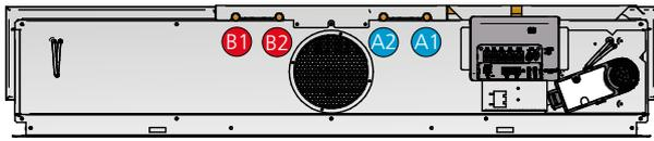
Abb. 22. Wasseranschluss an der Rückseite (WB).
