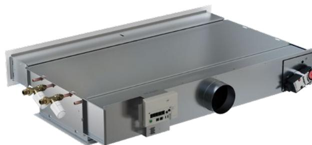
Abb. 13. WISE Paragon mit Wasseranschluss auf der linken Seite. Komplettes Produkt mit werkseitig montierter Steuereinheit WISE CU, Stellantrieben sowie Ventilen und Ventilstellantrieben für Kühl- und Heizwasser.
