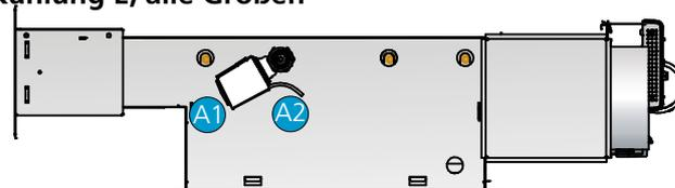
Abb. 21. Wasseranschluss auf der linken Seite.
