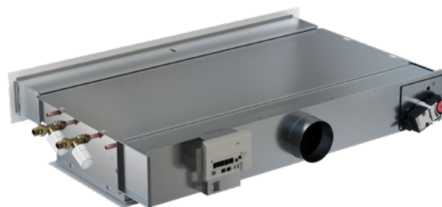
Figure 13. WISE Paragon avec raccordement hydraulique côté gauche. Produit complet avec module de commande WISE CU, servomoteurs, vannes et servomoteurs de vannes pour chauffage ou refroidissement par eau montés en usine.
