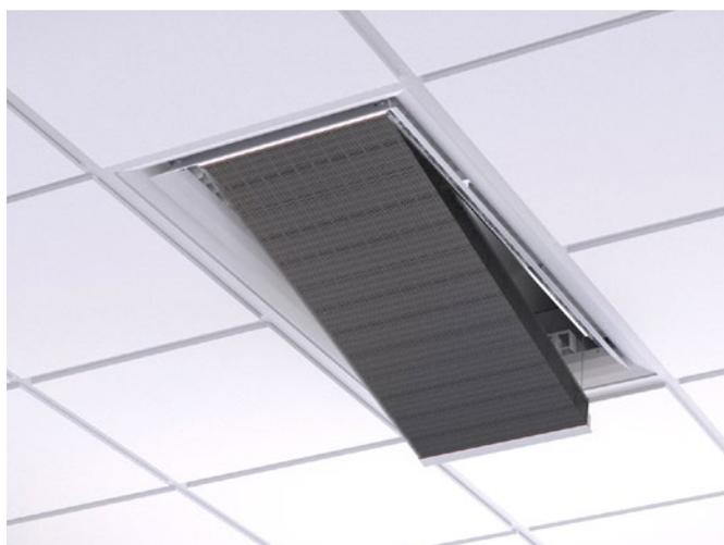
Figure 16. Dépose de la sous-face et sortie de la batterie pour un nettoyage poussé en cas d'exigences strictes en matière d'hygiène. Attention: le produit doit être commandé avec la batterie escamotable (option) et l'alimentation en eau doit se faire par le biais de flexibles de raccordement.
