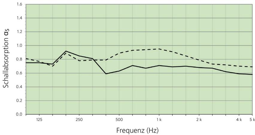
ohne Zusatzeinlage ——— mit Zusatzeinlage - - - -
