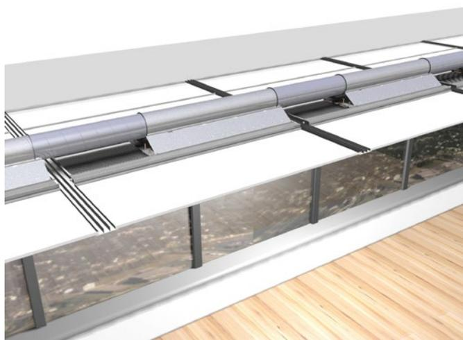
Figure 21. Poutres de climatisation PACIFIC (sans module SA/EA supplémentaire) raccordées en série.
