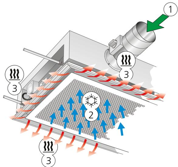
Abbildung 4. Variante X: Zuluft- und Heizungsfunktion mit Elektro-
