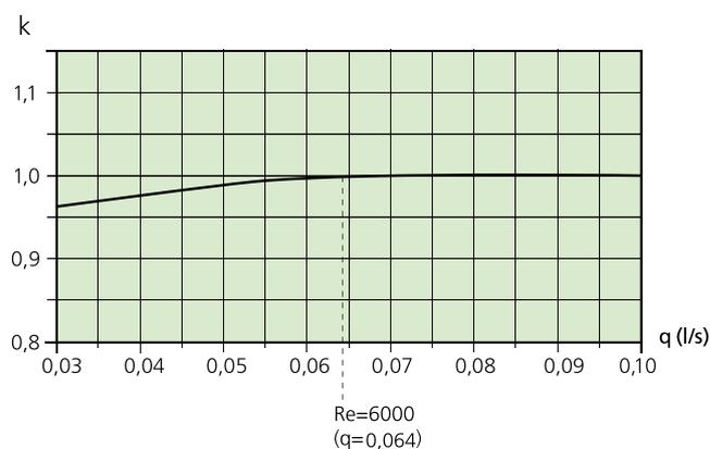
Diagramm 3. Korrigierte Kapazität – Volumenstrom Wasser, Parasol 1200
