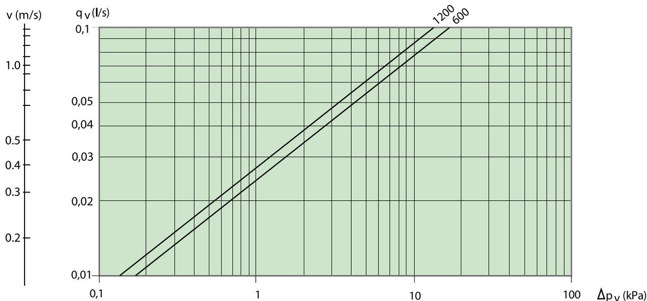
**Tabelle 9 - Daten - Heizung. Dimensionierungshilfe für die Einmoduleinheit Parasol MF**
