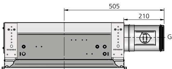
Abbildung 30. Anschluss mit Klappe, Vorderansicht
