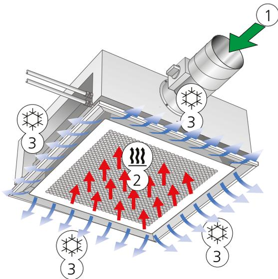
Abbildung 1. Variante A: Kühl- und Zuluftfunktion
