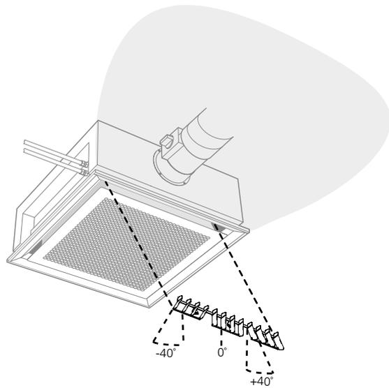
Abbildung 7. Einstellungsmöglichkeiten ADC<sup>II</sup>, Fan-shape
