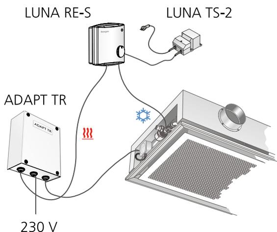
Abbildung 15. Wassergebundene Kühlung und Elektroheizung
