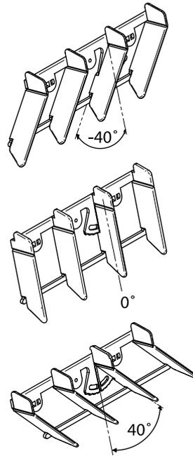
Abbildung 6. ADC<sup>II</sup>, Einstellungsbereich von -40° bis +40° in Schritten von 10°
