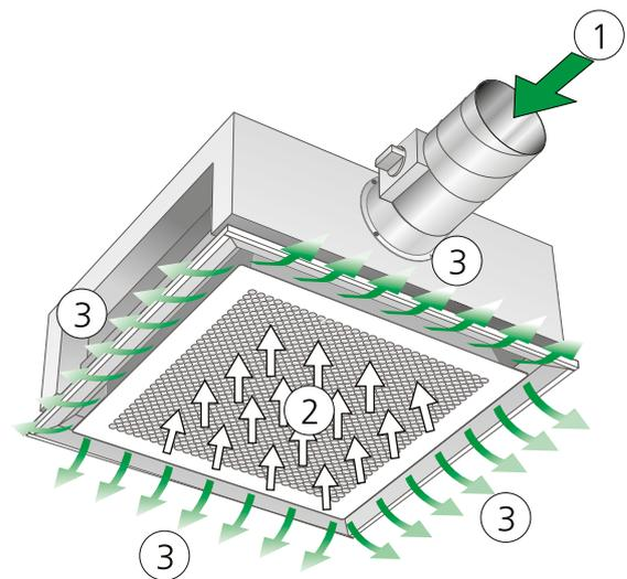
Abbildung 3. Variante C: Zuluftfunktion
