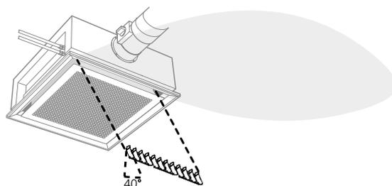
Abbildung 8. Einstellungsmöglichkeiten ADC<sup>II</sup>, X-shape
