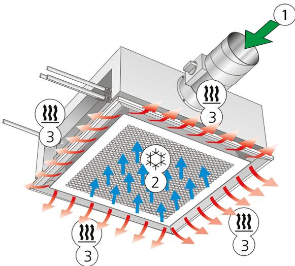
Abbildung 2. Variante B: Heizungs- und Zuluftfunktion (auch mit integrierter Kühlfunktion)
