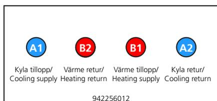
Abb. 17. Wasseranschluss.
