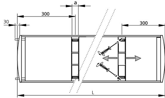
Abbildung 9. Horizontaler Anschluss im Endstück -H, Draufsicht.
