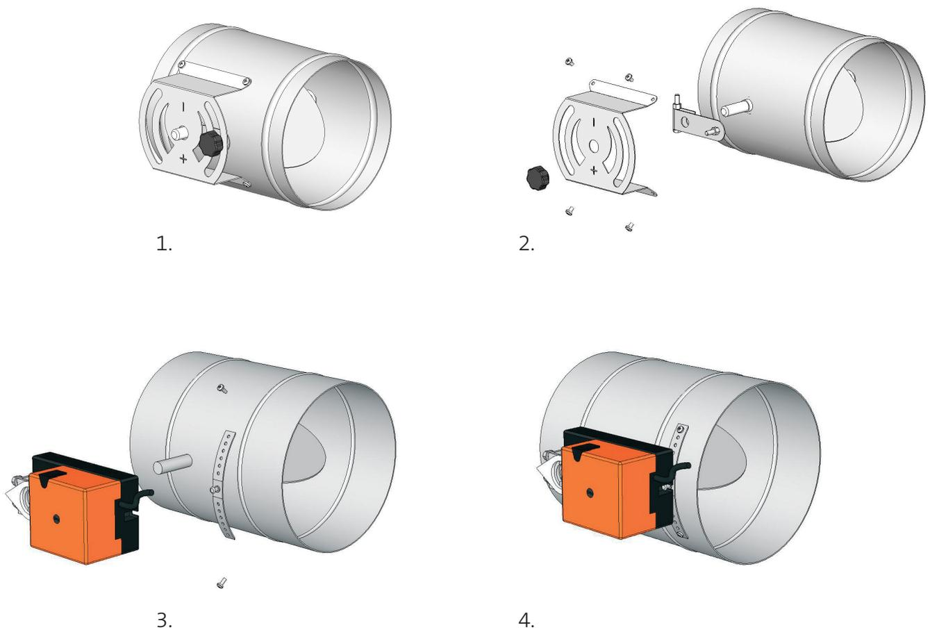
Die Handsteuerung abschrauben (siehe Abb. 2) und den Antrieb mit der entsprechenden Achsaufnahme der Regelklappe befestigen (siehe Abb. 3).
