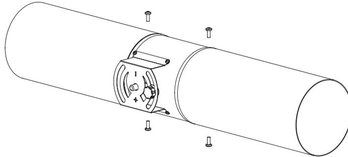
Bei Version MG/2 erfolgt die Verbindung mit Schrauben zwischen den Flanschen der Klappe und der Gegenflansche des Kanals.
