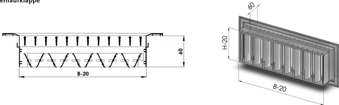
SV Zuluftgitter mit Gegenlaufklappe mit Lamellen parallel zur schmalen Seite, vollständig aus Aluminium, über die Vorderseite des Gitters mittels Schraubendreher verstellbar. Auf Anfrage kann ein Antrieb eingebaut werden (stetig oder auf/zu).
