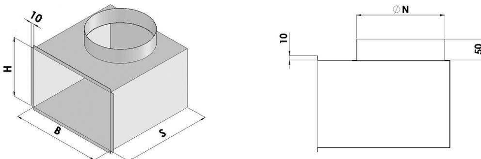
PS1-Standard Anschlusskasten in Sendzimir-verzinktem Stahl mit seitlichem Anschluss.
