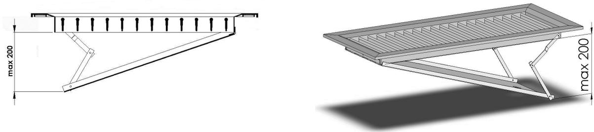
SV Gitter mit Schöpfungenregulierung, einflügelig, in Sendzimir-verzinktem Stahl, auf der Frontseite des Gitters manuell regulierbare Klappöffnung.
