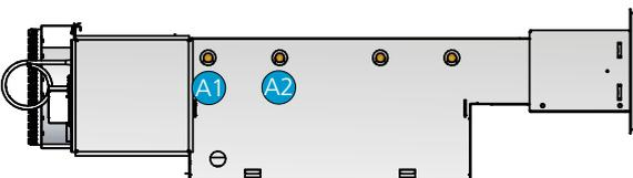
Abb. 22. Wasseranschluss auf der rechten Seite (R).
