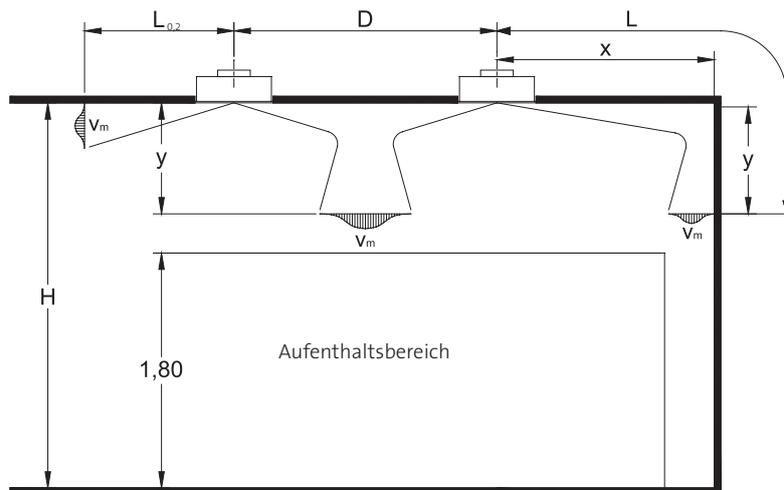
Die mittlere Strömungsgeschwindigkeit mit einer von den Diagrammen  $L_{0,2}$  abweichenden Entfernung  $x$  erhält man durch Verwendung der folgenden Formel:  $v_x = 0,2 \times (L_{0,2} / x)$
