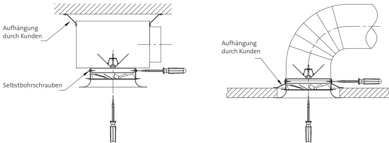
Diese Befestigung ermöglicht die Verwendung der von der Frontseite des Luftauslasses über eine Zentralschraube einstellbaren Flügelklappe SF.
