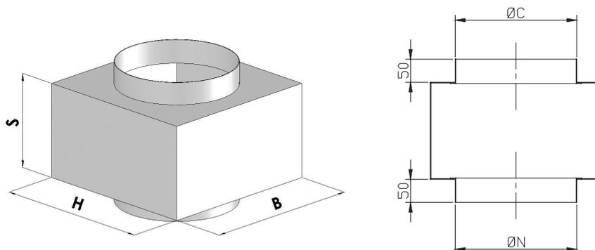
PS8-Standard Anschlusskasten in Sendzimir-verzinktem Stahl mit Anschluss von oben.
