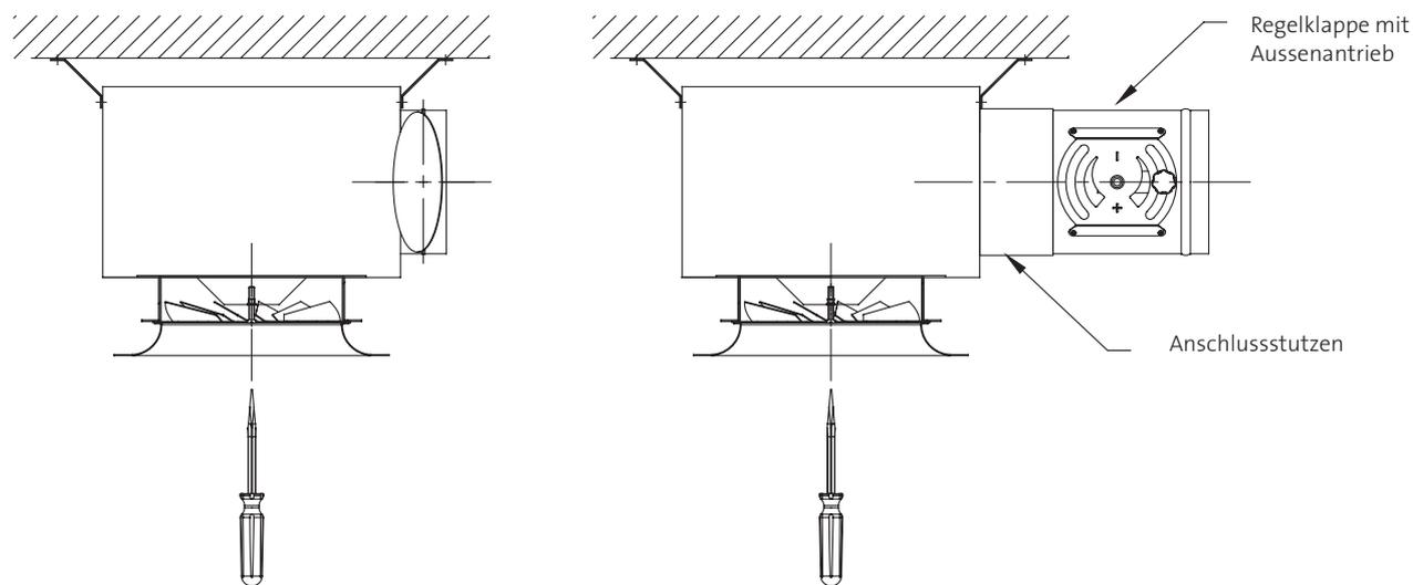
Diese Befestigung ermöglicht einen schnellen Einbau von der Vorderseite des Luftauslasses mit einer vorderen Zentralschraube und Befestigungsbügel im Inneren des Luftauslasses. In diesem Fall müsste eine Klappe auf dem Anschluss des Anschlusskastens eingebaut werden.
