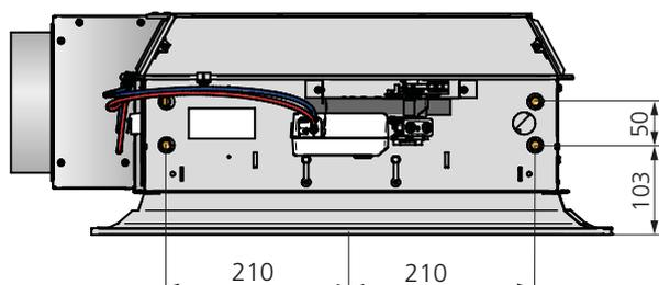
Figure 24. Dimensions, longueur du raccord hydraulique 600, 1200, 1800
