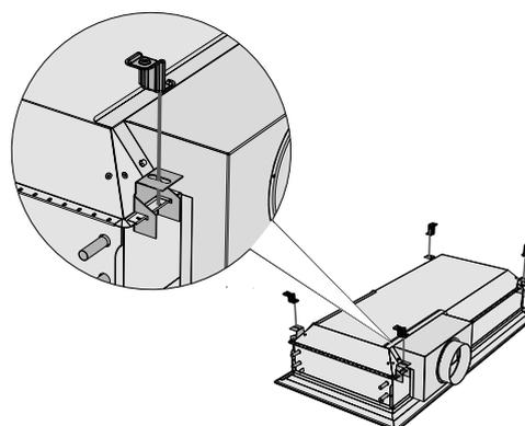
Figure 21. Suspension par quatre consoles avec SYST MS M8
