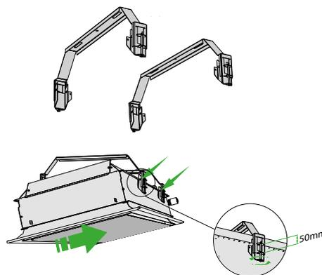
Figure 22. Fixation au moyen du KIT DE SUSPENSION RAPIDE PARASOL Z
