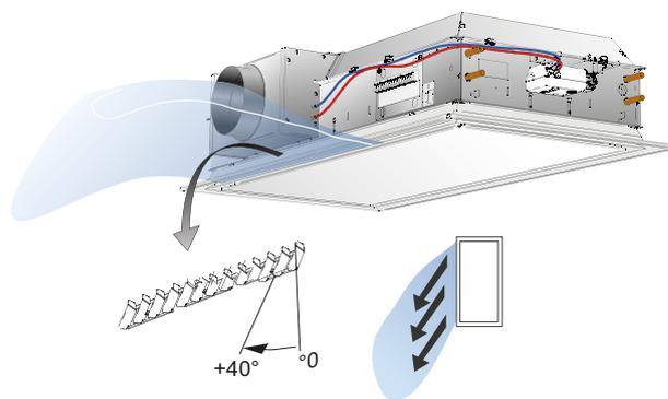
Figure 8. Options de réglage de l'ADC, en X
