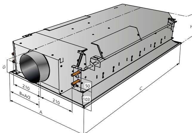
Figure 28. Schéma de dimensionnement – raccordement sur côté court (l'exemple montre une longueur 1200 avec raccordement aéraulique sur le côté 1).
