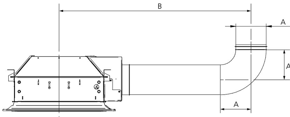
Figure 29. Schéma de dimensionnement, raccordement côté longueur, avec coude Ø125/160/200
