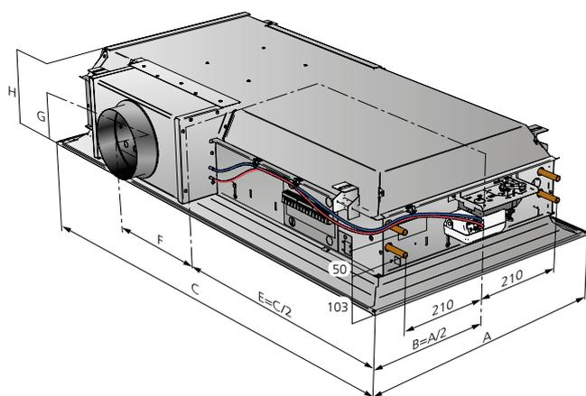
Figure 27. Schéma de dimensionnement – raccordement sur côté long (l'exemple montre une longueur 1200 avec raccordement aéraulique sur le côté 2).
